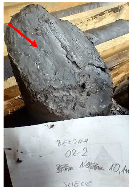
fot.42. Ścięcie 10,1 m ppt.
