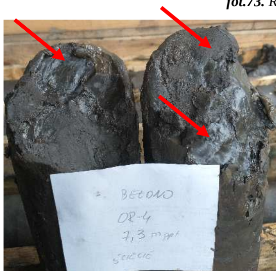
fot.74. Ścięcie 7,3 m ppt.
