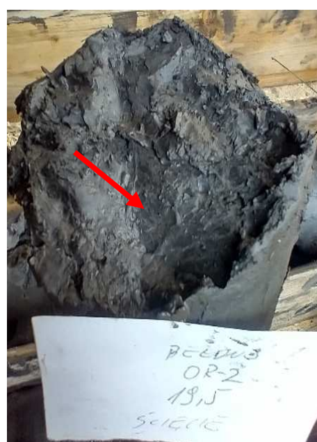
fot.45. Ścięcie 19,5 m ppt.
